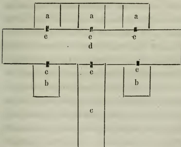
a : formes pour les vaisseaux de ligne. — b : formes pour les frégates. — d : bassin. — e : portes écluses. — c : caual de communication avec la mer.
